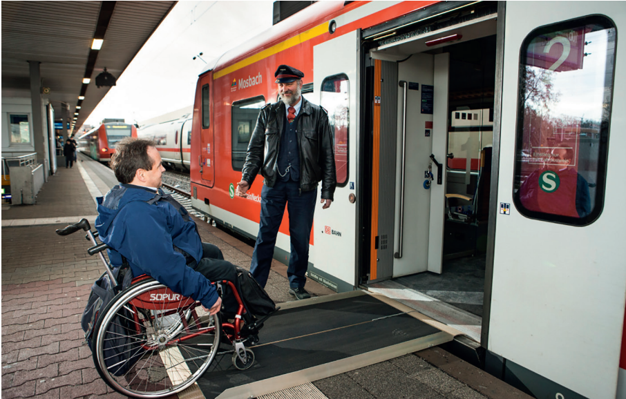
Abb. 13: Nutzung einer Einstiegshilfe, hier mobile Rampe
