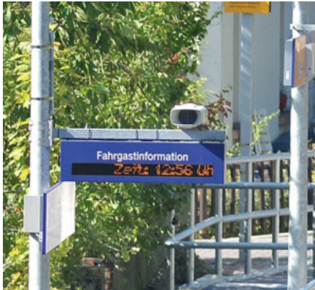
Abb. 8: Dynamischer Schriftanzeiger mit Akkustikmodul, Bad Karlshafen
