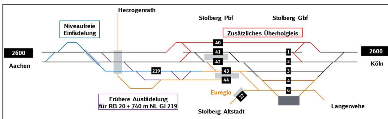
Abbildung 32: Zusätzliches Überholgleis, niveaufreie Einfädung und frühere Ausfädung für die RB 20 in Stolberg Hbf
