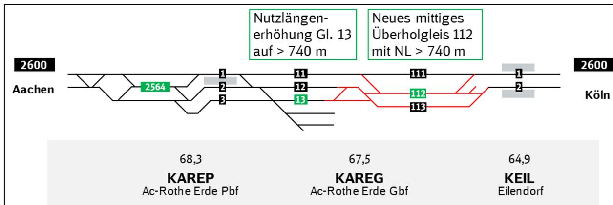
Abbildung 28: Weiteres mittleres Überholgleis in Aachen-Rothe Erde
