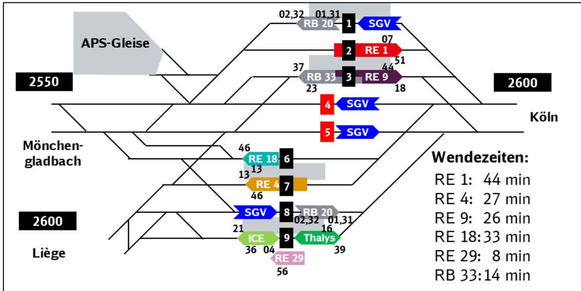
Abbildung 13: exemplarische Gleisbelegung in Aachen Hbf (vormittags)
