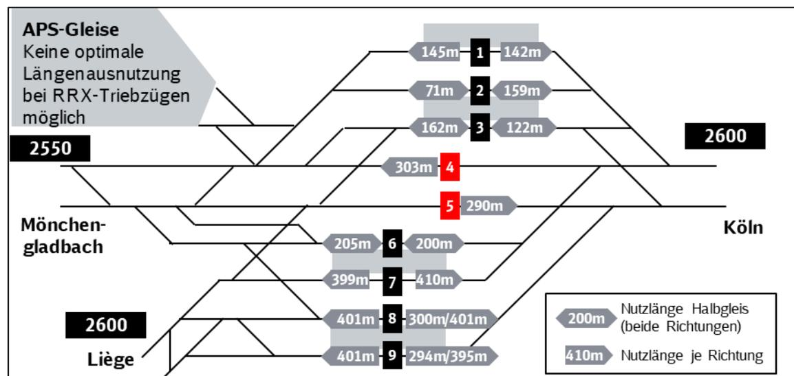
Abbildung 12: Gleisplan von Aachen Hbf
