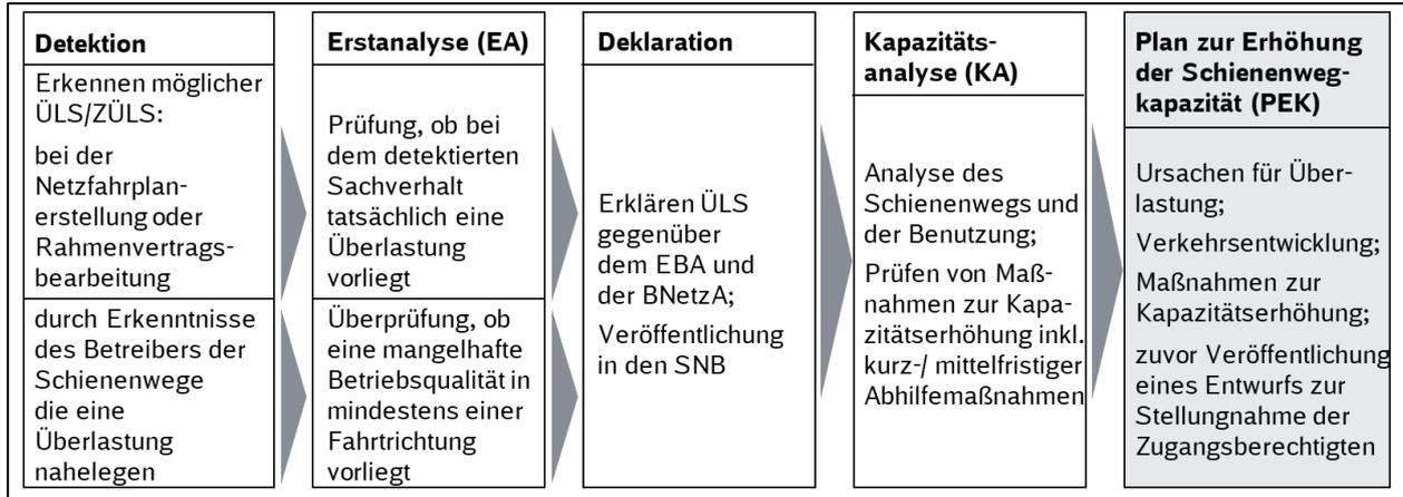
Abbildung 1: Prozesse im Zusammenhang mit überlasteten Schienenwegen
