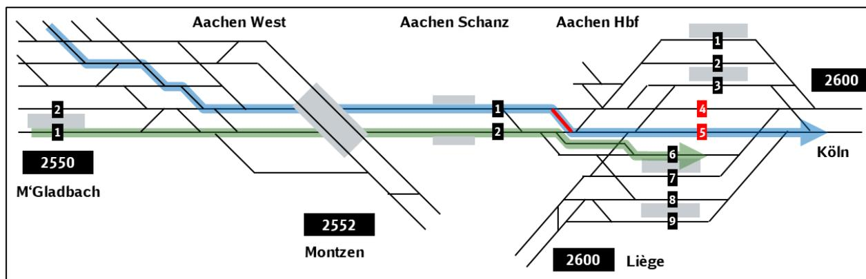
Abbildung 23: Zusätzliche Weichen ermöglichen eine Parallelfahrten von Aachen West nach Aachen Hbf
