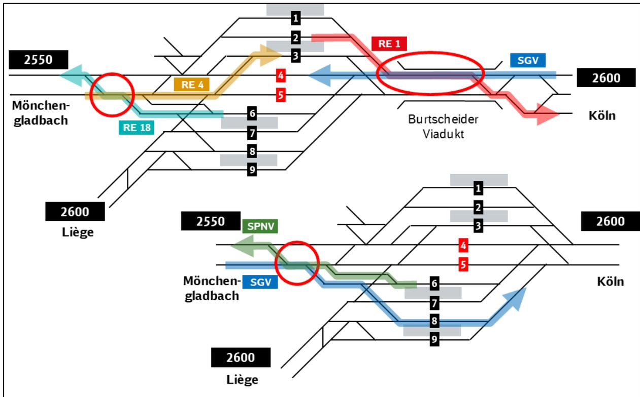
Abbildung 15: Fahrwegkreuzungen in Aachen Hbf
