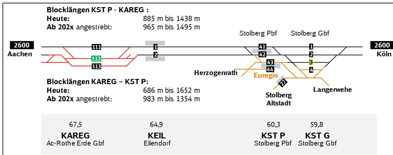
Abbildung 29: Im Abschnitt Stolberg - Aachen-Rothe Erde wird die Signaltechnik auf ESTW umgestellt
