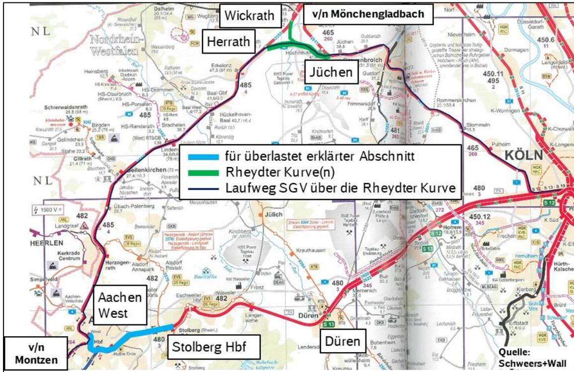
Abbildung 34: Zusätzlicher Laufweg der Güterzüge über die Rheydter Kurve
