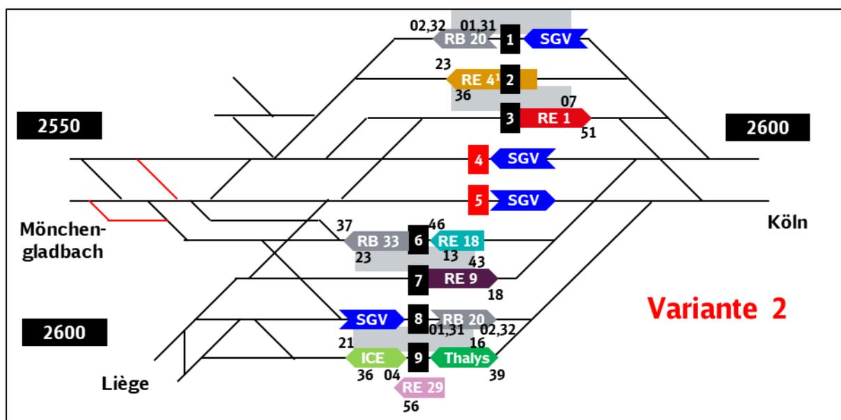
Abbildung 27: Variante 2 einer künftigen Gleisbelegung
