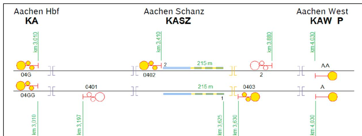
Abbildung 20: Zusätzliche Blocksignale im Abschnitt Aachen Hbf – Aachen West
