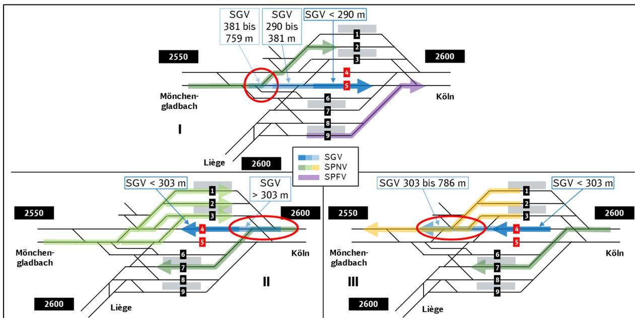
Abbildung 16: Die Nutzlängen von Gleisen 4 und 5 in Aachen Hbf sind zu kurz für Betriebshalte von Güterzügen
