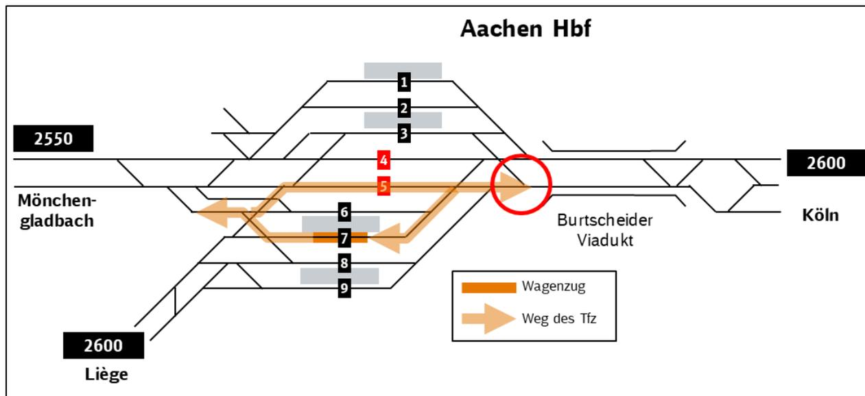
Abbildung 14: Triebfahrzeugumlauf in Aachen Hbf
