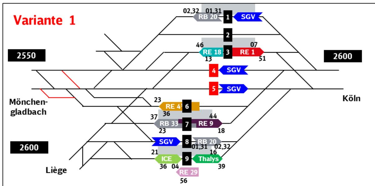
Abbildung 26: Variante 1 einer künftigen Gleisbelegung
