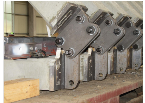
Biegesteifes Koppelgelenk im geklappten Zustand
