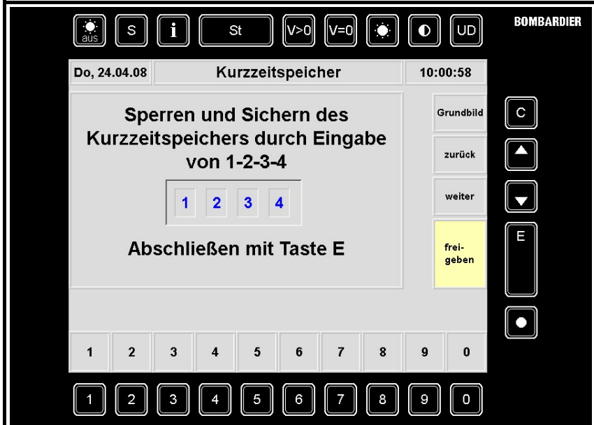
Bild 36 DSK Kurzzeitspeicher freigeben
